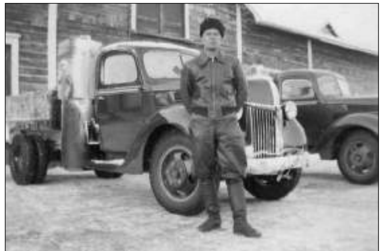
Sotavuosina ja vielä niidenkin jälkeen varustettiin kuorma-autot häikäpöntöin. Moottoritehot putosivat siitä, mitä ne bensiinikäyttöisinä olivat olleet.
