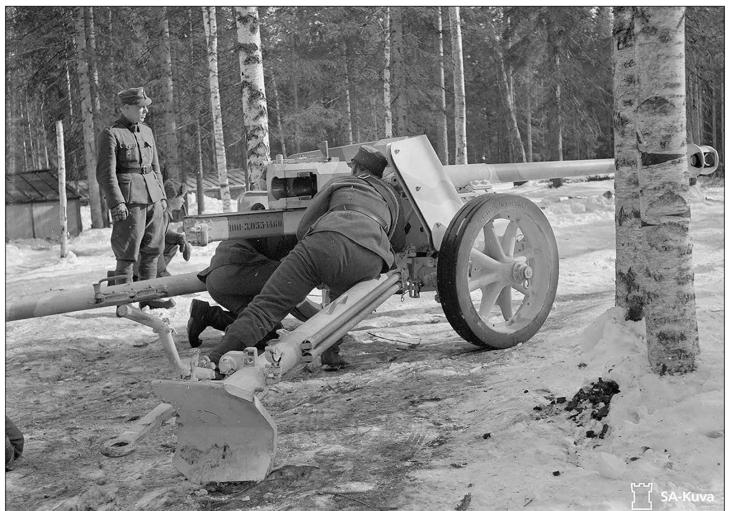
75 K/40-kanuunalla harjoitellaan. Tykin panssarintorjunta-ammukset olivat panssarikranaatti, panssariammus ja ontelokranaatti. Muita maaleja ammuttiin sirpalekranaatein.
