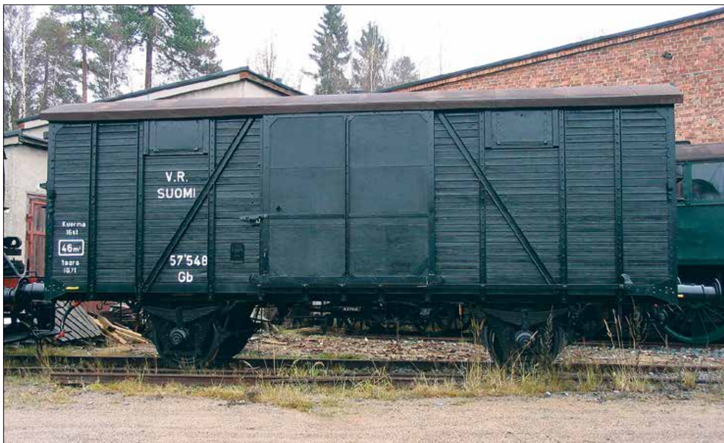
Gb-sarjan umpitavaravaunu edusti jatkosodan aikana maamme moderneinta tavaravaunukalustoa. Vaunun suurin kuorma oli 16,5 tonnia ja tilavuus 46 m³. Yleisemmässä, pienempikokoisemmassa Gd-sarjan vaunussa tilavuutta oli vieläkin vähemmän, vain 36 m³, mutta kuorma oli sentään sama. Nykyaikaisessa umpitavaravaunussa kuorma voi olla 72 tonnia ja tilavuus jopa 190 m³.
