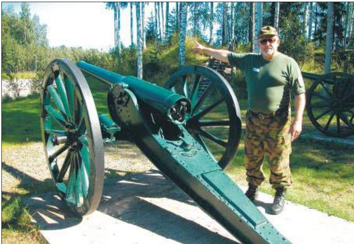
”Hyppyheikki”, ranskalaisvalmisteinen 90 mm tykki vuodelta 1890. Tykin kantomatka on 8 km ja nimitys Hyppyheikki johtuu siitä, että tykinputkesta puuttuu luisto. Laukaistaessa tykki hyppäsi muutamia kymmeniä senttejä taaksepäin. Esittelijä on museon ”pääopas”, Pohjois-Karjalan Sotilaspoikien perinnekillan puheenjohtaja Pentti Kankaanrinta.
