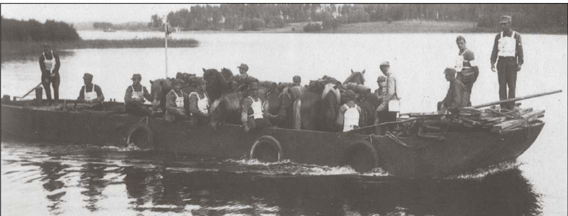
Antrean 1929 nimetystä moottoriponttonisuojeluskunnasta muodostettiin syyskuussa 1939 kenttä- armeijamme ainoa Erillinen moottoriponttonipataljoona hoitamaan Vuoksella ja jatkosodassa Syvä- rillä ja Kiantajärvellä vesistökuljetuksia. Ponttonilla voitiin kuljettaa 114 miestä tai yhdeksän hevosta. Kahden ponttonin päälle rakennetulla lautalla kulki kiväärikomppania. Harjoituksia ja koulutustilai- suuksia pidettiin 1930-luvulla kesäsunnuntaisin. Kesän 1939 suurissa sotaharjoituksissa koko kalus- to oli ensimmäisen kerran käytössä.
