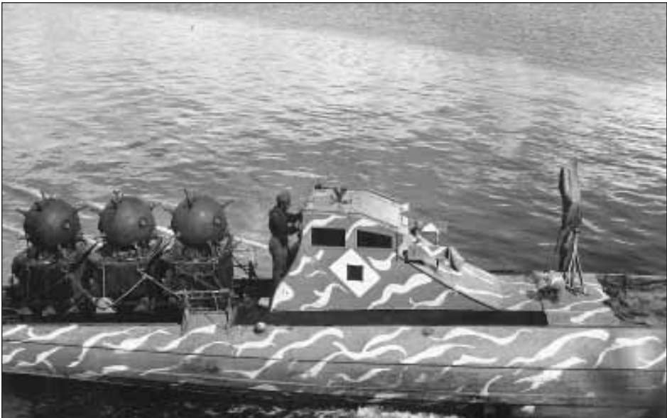
Mtv Syöksyn tunnus oli ruutuässä. Kuvassa kesältä 1942 veneellä on torpedokuilun päällä kolme kosketusmiinaa. Kuva: SA-kuva 101797
