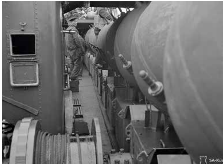
Pitkät rivit antennimiinoja (EMC) odottavat tiputusvuoroaan miinalaiva Ruotsinsalmen kannella toukokuussa 1942.
